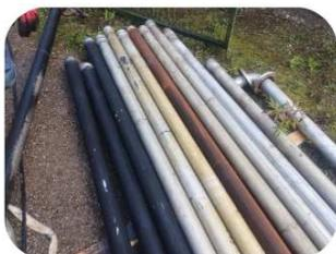
› 12 tubes de 6 mètres, utilisés pour un forage de profondeur 180 mètres
